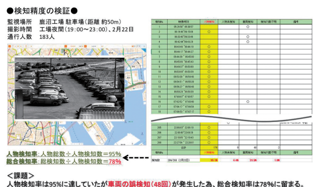
図5 鹿沼工場での検知精度検証(1回目)
